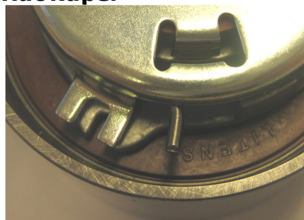
Εικ. 1 Ελατήριο που έχει λασκάρει
